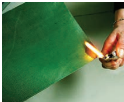
تصویر ۷- نانوپارچه ضد حریق
